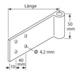
Schnellmontage-Kreuzband vertikal und horizontal verstellbar (alternativ)
